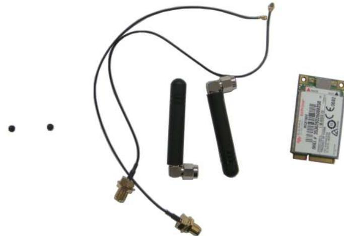
802.11b/g QN-MU-A0028 wireless mini card module kit INTEL112.BNHWG
