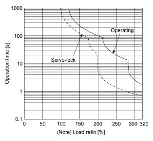
HF-KN13\_, HF-KN23\_, HF-KN43\_ HF-KN73\_, HF-SN52\_, HF-SN102\_ HF-SN152\_, HF-SN202\_, HF-SN302\_
